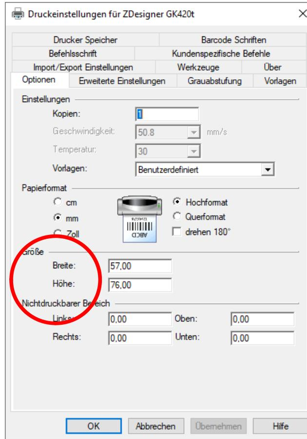
Stellen Sie sicher, dass Drucker auf richtiges Etikettenformat Breite x Höhe eingestellt. Siehe Bild für 57x76mm Etiketten
