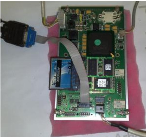
*Foto verwendet COM2 für RFID! Rote Markierung Flachbandkabel zeigt nach RECHTS! Grüne LED am RFID Leser muss nach dem Einschalten leuchten!*
