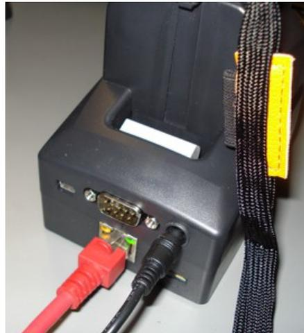
**Achtung:** Die Netzwerkverbindung kann erst konfiguriert werden, nachdem der Handheld in die LAN Basis Station eingesteckt wurde! Kontrollieren Sie die LAN Lampen an der Rückseite. Diese müssen leuchten und so einen LAN Traffic anzeigen!
