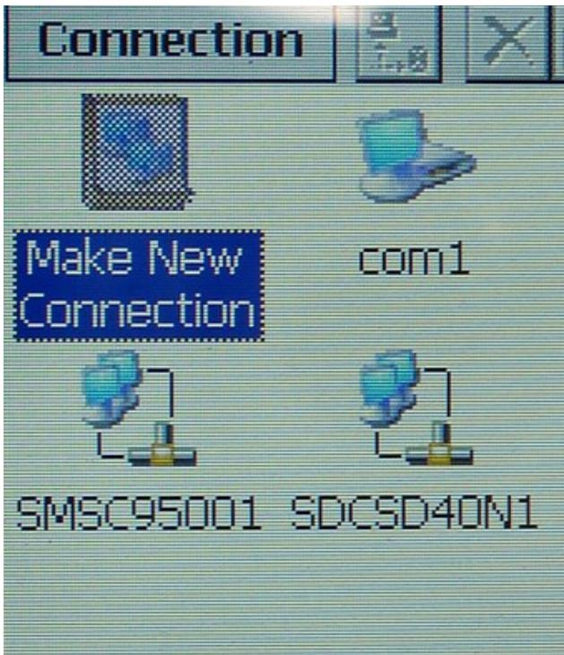
LAN Verbindung: Auf SMS... klicken. Achten Sie darauf, dass Sie die LAN Verbindung auswählen – nicht die WLAN Verbindung. Die LAN Verbindung ist nur sichtbar, wenn sich der Handheld in der Basis Station befindet!
