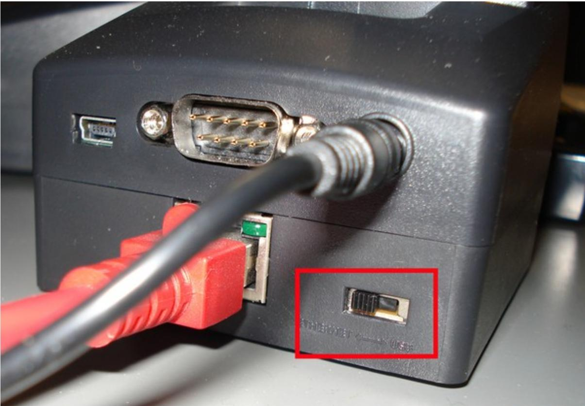
Kontrollieren Sie die LAN Lampen an der Rückseite. Diese müssen leuchten und so einen LAN Traffic anzeigen! Sind die Lampen aus, wenn der Handheld in der Basis Station steckt, haben Sie wohl keine Netzwerkverbindung!
