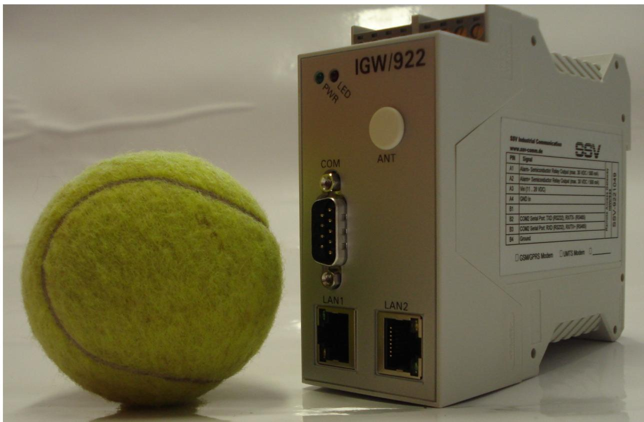
Das IGW922 bildet ein in weiten Teilen konfigurierbares Gateway für Industrie- und Embedded Einsatzbereiche. Es lassen sich Daten beliebiger Datenquellen aufnehmen und automatisiert in IP Subnetze weiterleiten / bereitstellen oder einbinden. Optional steht für beliebige Ethernet-basierte Geräte eine VPN Funktion (Virtual Private Network) zur Verfügung, so dass ein sicherer Fernzugriff per Internet ermöglicht wird.
